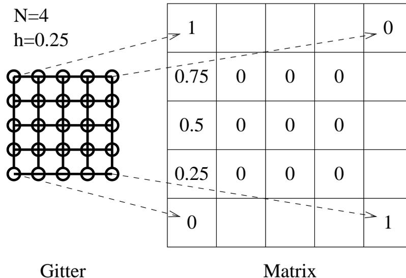
Dieses Gitter kann in einer  $(N + 1) \times (N + 1)$ -Matrix gespeichert werden. Jeder Eintrag in der Matrix repräsentiert einen Punkt des Gitters. Die Randpunkte des Gitters werden vor Beginn der Berechnung vorgelegt.
