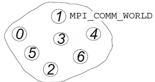
In einem Programm können mehrere Kommunikatoren gleichzeitig definiert werden.
