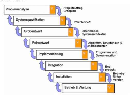
**Abbildung**: Aufbau des erweiterten Wasserfallmodells **Quelle**: winfwiki.wi-fom.de
